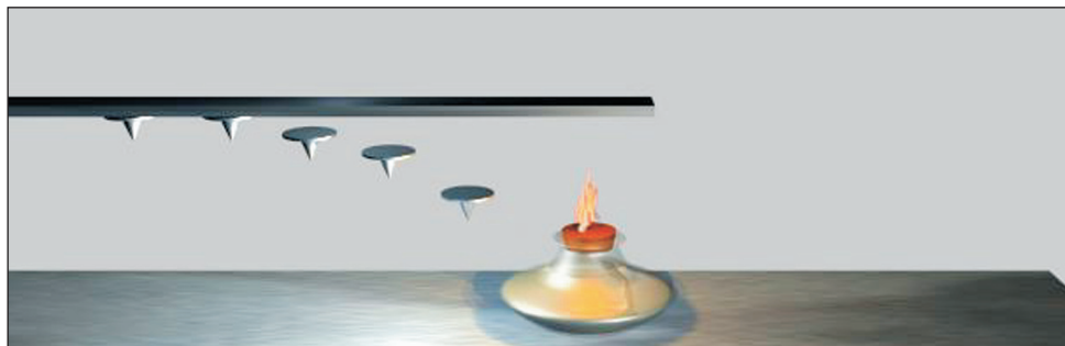
Рис. 23. Опыт, доказывающий теплопроводность металлической пластинки (кнопки приклеены к пластине легкоплавким веществом)
