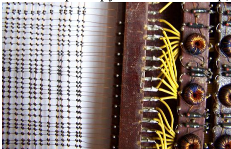
Магнитное ОЗУ: слева – биты памяти, справа – устройство выборки нужного адреса
