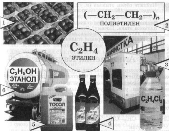
Рис. 19. Применение этилена: 1 — в овощехранилищах для ускорения созревания плодов; 2—6 — производство органических соединений (полиэтилена 2, растворителей 3, уксусной кислоты 4, спиртов 5, 6)
