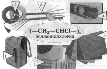
Рис. 23. Применение поливинилхлорида: 1 — искусственная кожа; 2 — изолянта; 3 — изоляция проводов; 4 — трубы; 5 — динолеум; 6 — клеенка
