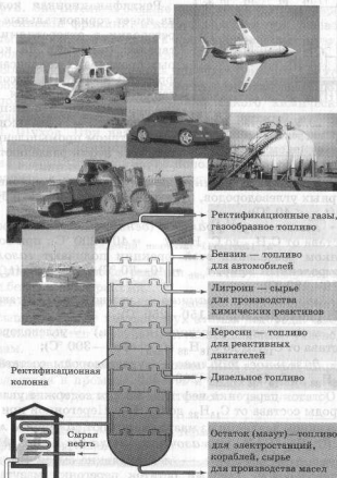
Рис. 28. Схема установки (ректификационной колонны) для непрерывной перегонки нефти и области применения нефтепродуктов
