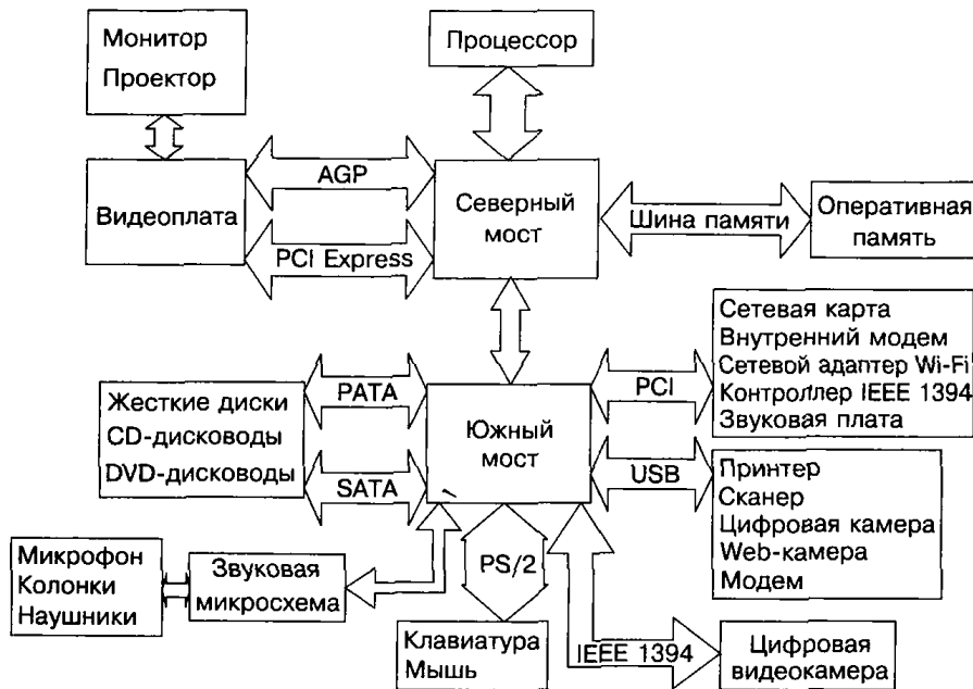
Рис. 1.3. Логическая схема системной платы
