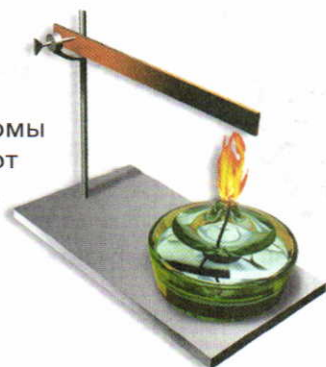
При прокаливании медной пластинки образовалось новое вещество — оксид меди.
