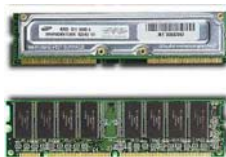
Рис. 2.6. Микросхемы памяти RIMM (сверху) и DIMM (снизу)
