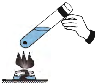
Рис. 97. Наблюдение теплообмена в воде конвекцией
