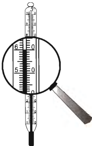
Рис. 29. Определение цены деления термометра
