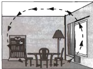
Рис. 104. Схема круговорота воздуха в комнате
